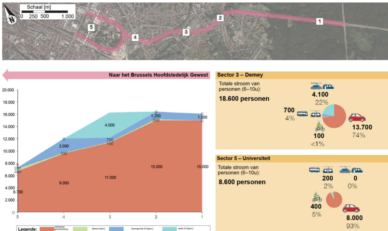
Afbeelding 291: Ontleding van de inkomende stromen op de as Herrmann-Debroux (toestand 2018) – Ochtendspits (bronnen: Gewestelijk Mobiliteitsplan, Smarteam* – in uitvoering)
