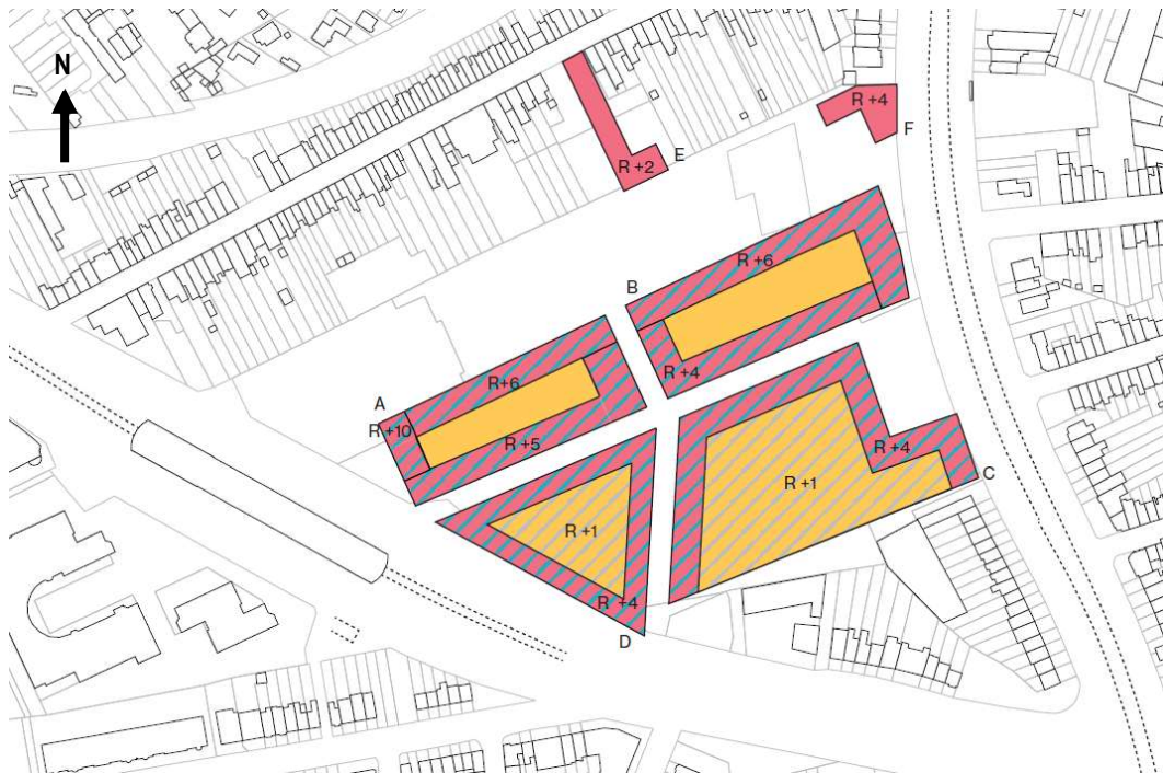
Figure 1108 : Gabarits maximaux prévus pour le site Demey et ses abords (ARIES sur fond ORG 2 , 2018)
