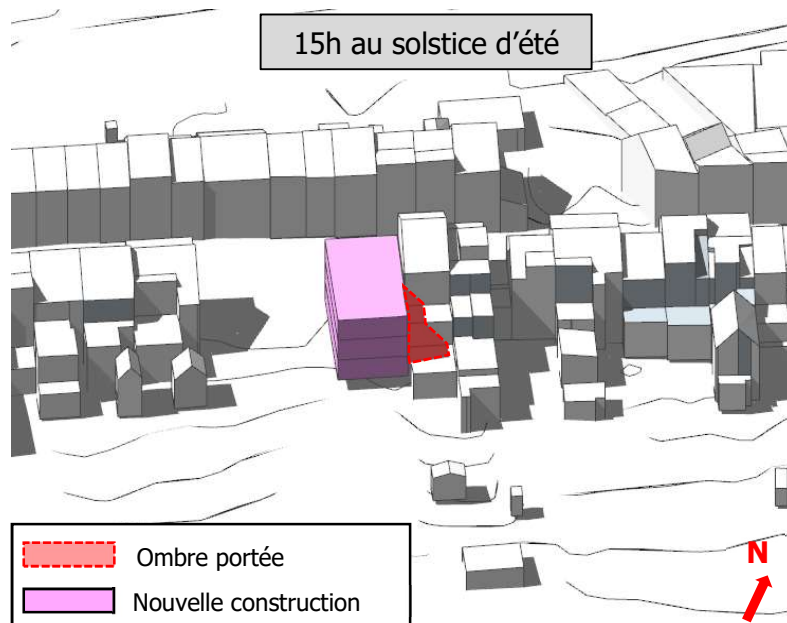
Figure 889 : Ombre portée du nouveau bâtiment situé rue de la Vignette sur l'habitation située au n°70 lors du solstice d'été (ARIES, 2018)
