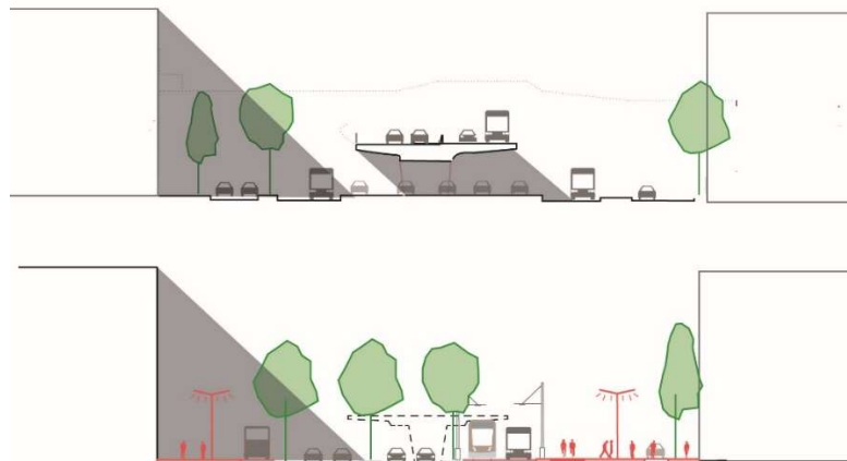
Figure 680 : Incidence de la suppression du viaduc sur l'ensoleillement de l'espace public (ORG 2 , 2018)
