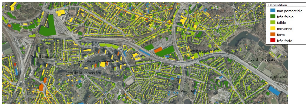
Figure 306 : Thermographie aérienne (Bruxelles Environnement, 2008)
