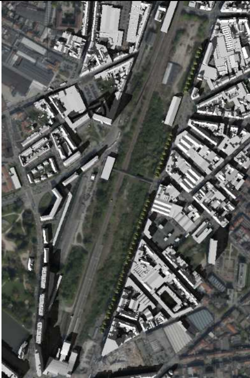
Figuur 167 : Simulatie van de schaduw in de bestaande toestand op 20/03 om 15u00 (Bron : ABO)
