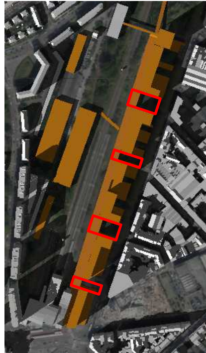
Figuur 230 : Simulatie van de schaduw op het kwadrant wijk in de geplande toestand op 22/09 om 16u00 (Bron : ABO)
