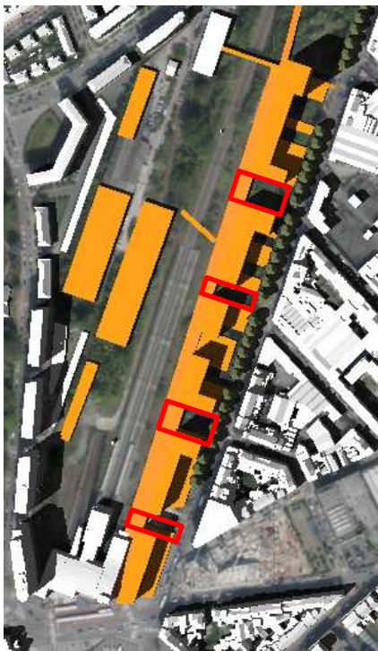
Figuur 225 : Simulatie van de schaduw op het kwadrant wijk in de geplande toestand op 21/06 om 15u00 (Bron : ABO)
