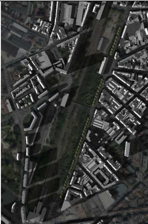
Figuur 185 : Simulatie van de schaduw in de bestaande toestand op 22/09 om 17u00 (Bron : ABO)
