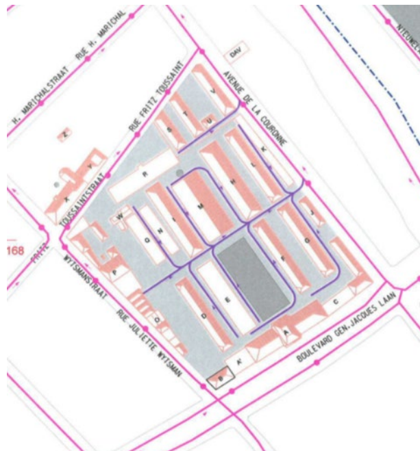
Figure 70: Réseau d'égouttage (Buur)
