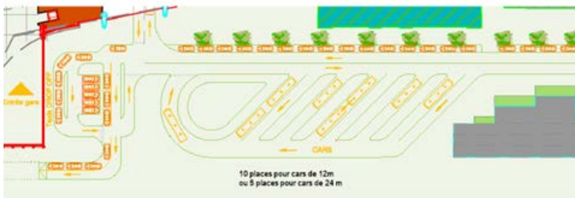
Illustration 85 : vue en plan – file d'attente des taxis rue de France et espace de débarquement
