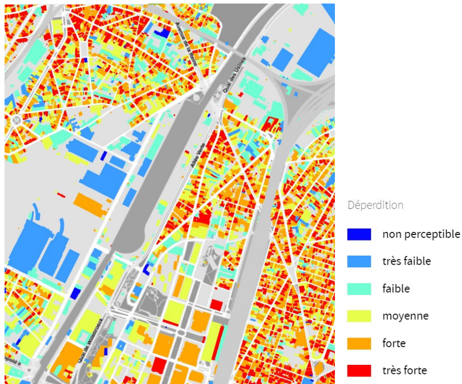
Figure 19. Thermographie aérienne des toitures des bâtiments du TN en 2008 (Source : Bruxelles Environnement)
