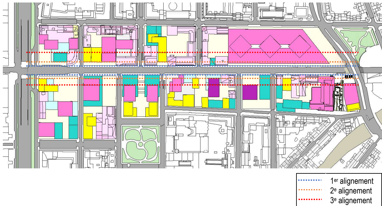
Figure 17 : Alignements prévus dans le PuL comparés avec l'implantation des constructions dans l'alternative 3
