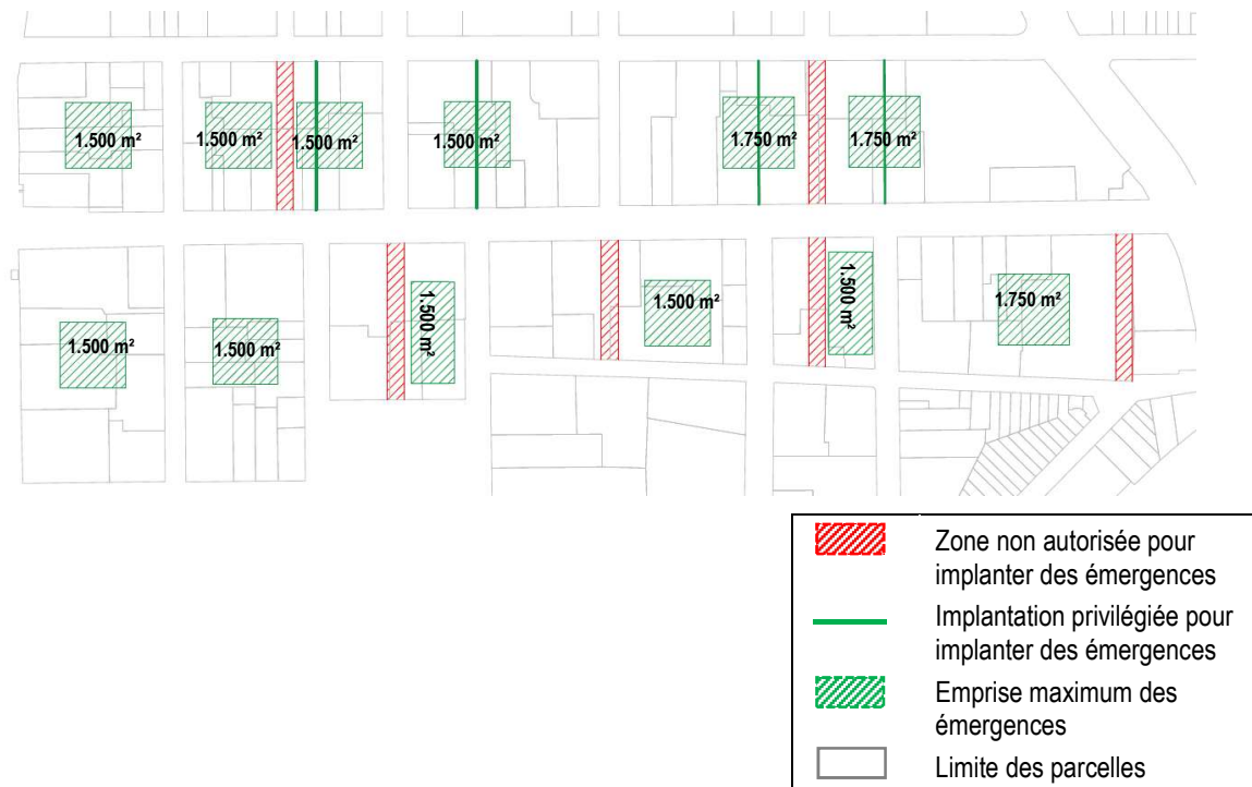
Figure 203 : Conditions d'implantation des émergences (ARIES, 2019)
