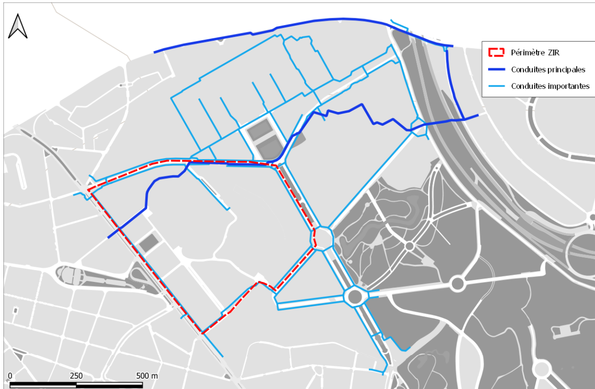
Figure 47 : Réseau de distribution du périmètre étudié (ARIES d’après Vivaqua, 2020)
