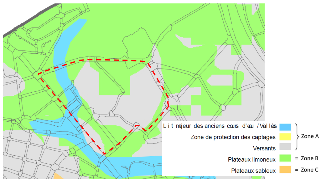
Figure 59 : Zones potentielles d'infiltration d'eau pluviale (Bruxelles Environnement, 2014)
