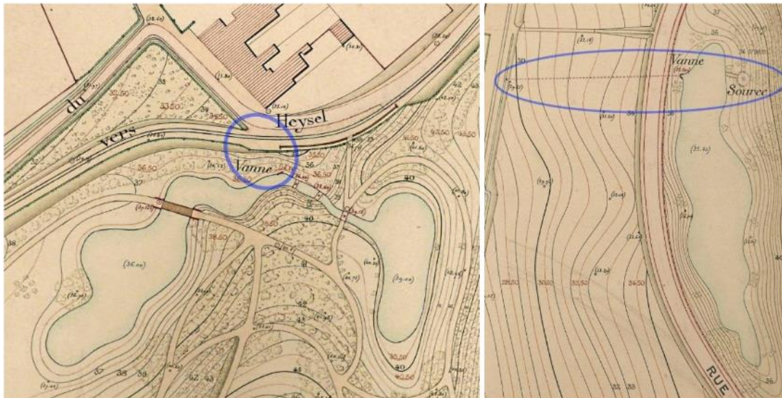
Figuur 30: Kleppen en waterleidingen die de bronnen en vijvers van Stuyvenberg met de Heizelbeek verbinden op de topografische kaart van commandant Serrane van 1890
