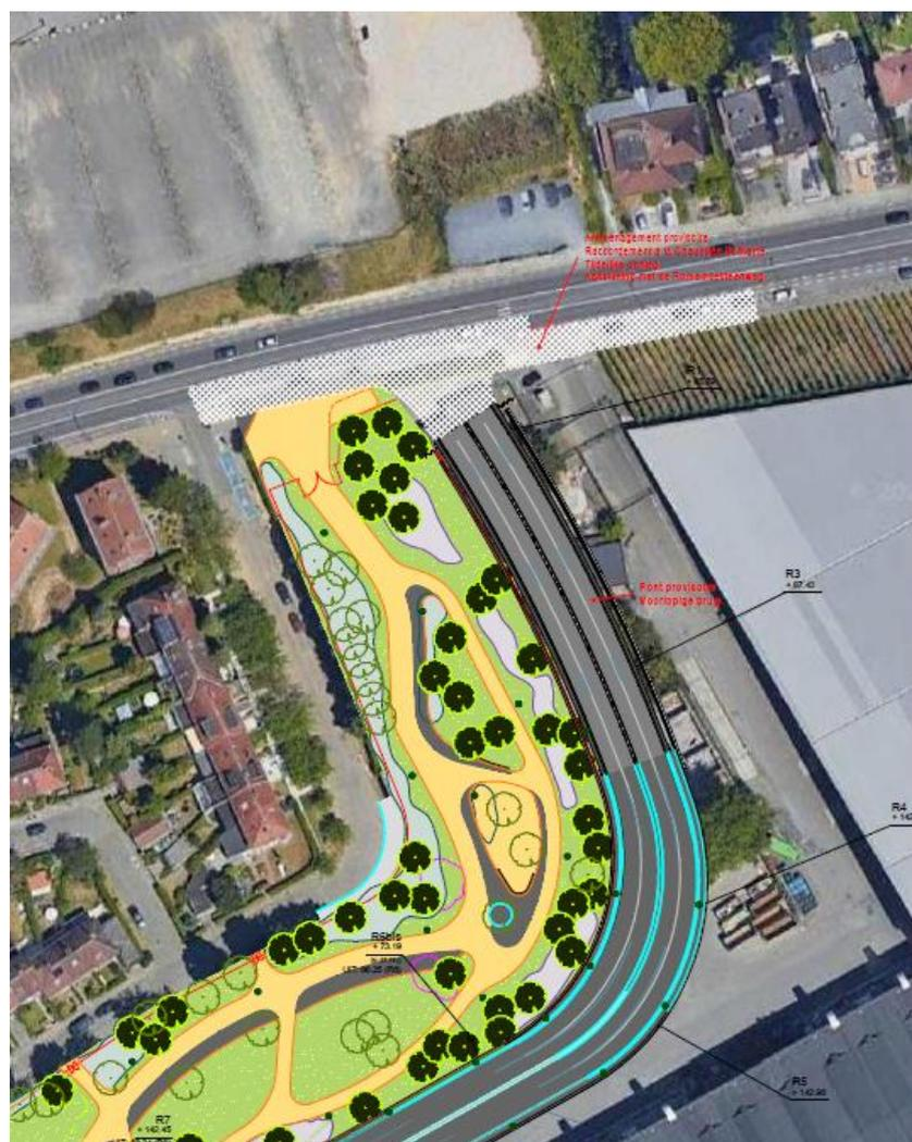
Figure 107 : projet de voie de liaison avec connexion provisoire à la chaussée Romaine.
